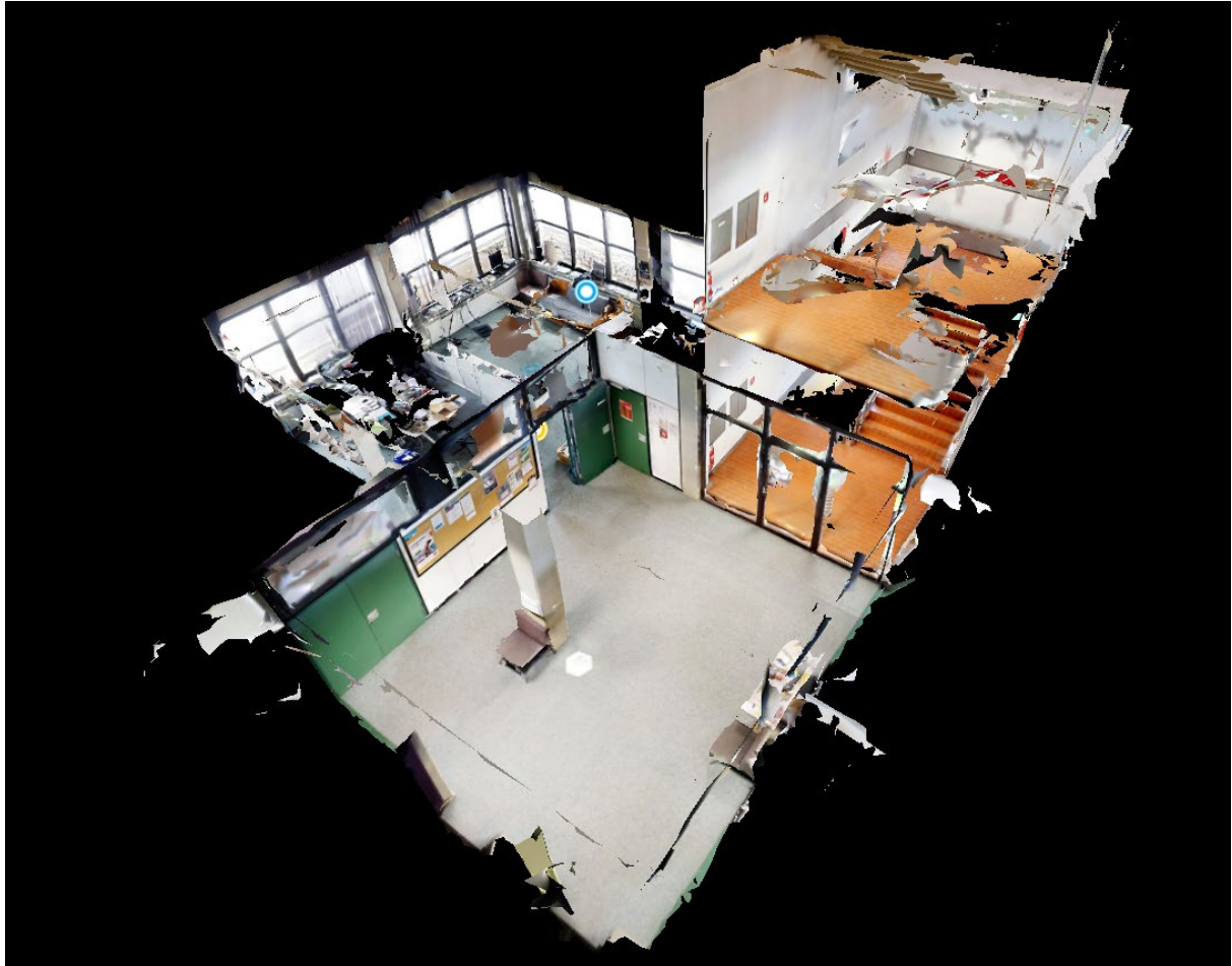
Abb. 3: Resultierendes 3D-Modell des beschleunigten Scannverfahrens. „Kap05_Abb03_LocationScan.tif“
